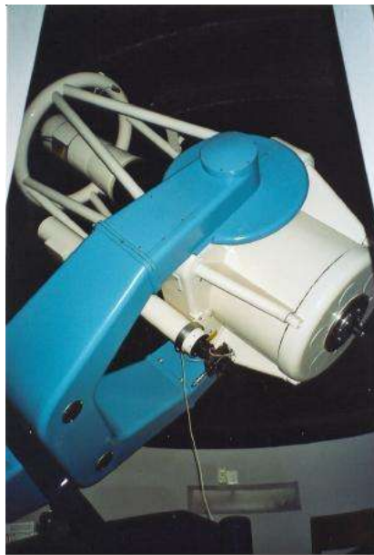
O telescopio Ritchey-Chretien de 0,62 m. de apertura
