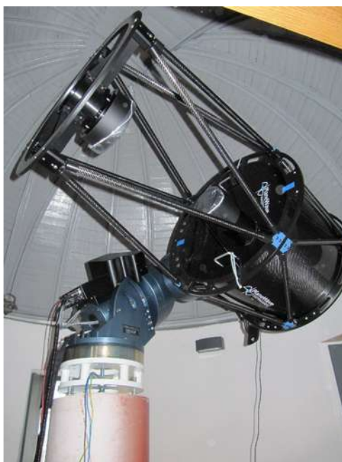
O telescopio Planewave de 0,51m. de apertura
